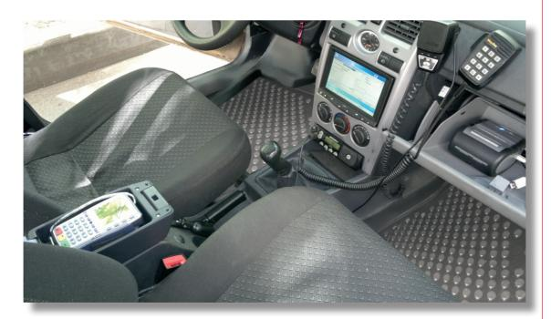
Все компоненты оборудования устанавливаются в салоне автомобиля стационарно путем крепления к элементам кузова или внутренней обшивки салона автомобиля с обязательным учетом требований документации изготовителя оборудования по его размещению, монтажу и подключению.
